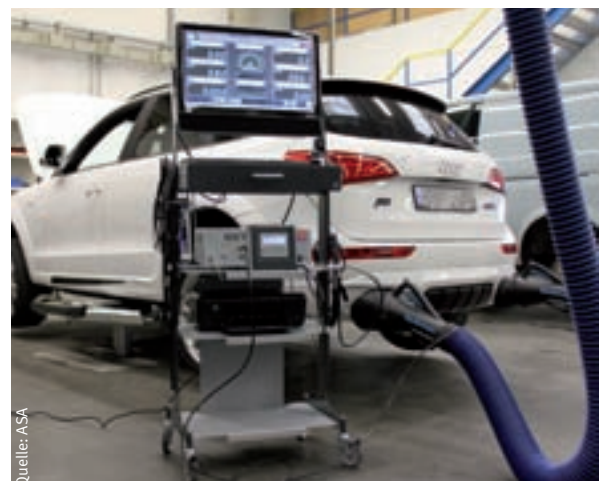
Bild rechts: Quelle ASA, Abgastülle mit Innenklemmvorrichtung bei der Abgasuntersuchung
