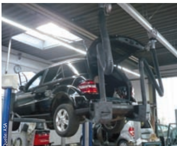
Bild links: Saugschlitzkanal mit 2 Saug-einheiten für 2-flutige Aus-puffanlagen
